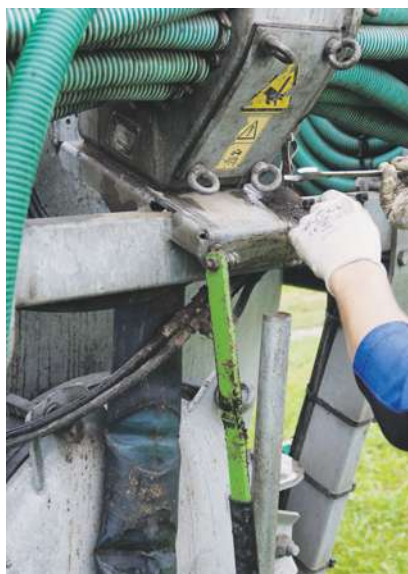
Zugang für Problembehebung: Öffnen des Verteilkopfes.
