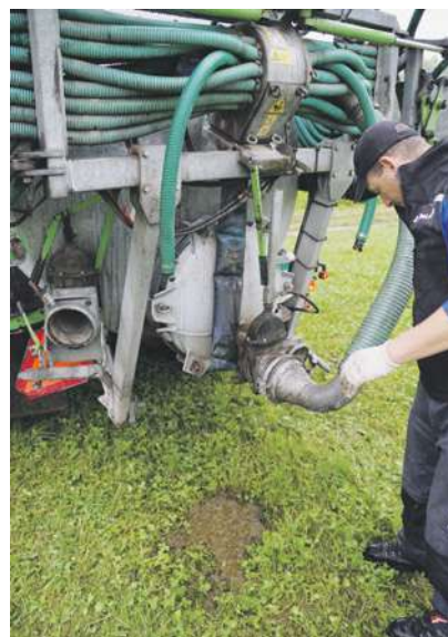
Ein Gummisack (hier geöffnet) fängt Fremdkörper vor dem Verteilkopf auf.
