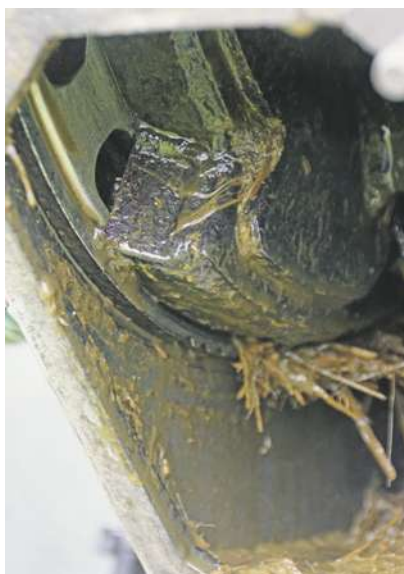
Messer im Verteilkopf vermindern Verstopfungen im Schlauch.
