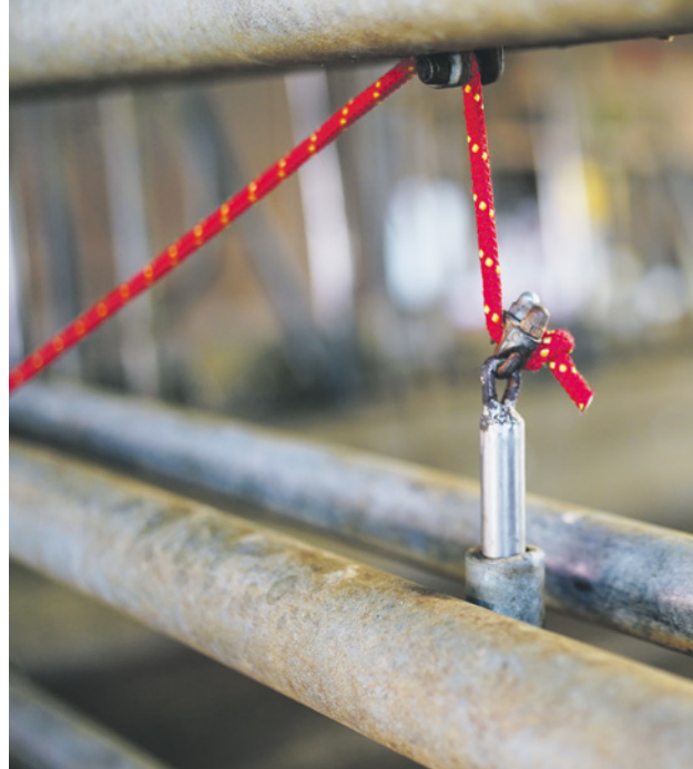
Die Metallstangen lassen sich mit der Nylonschnur bequem anheben und absenken.
