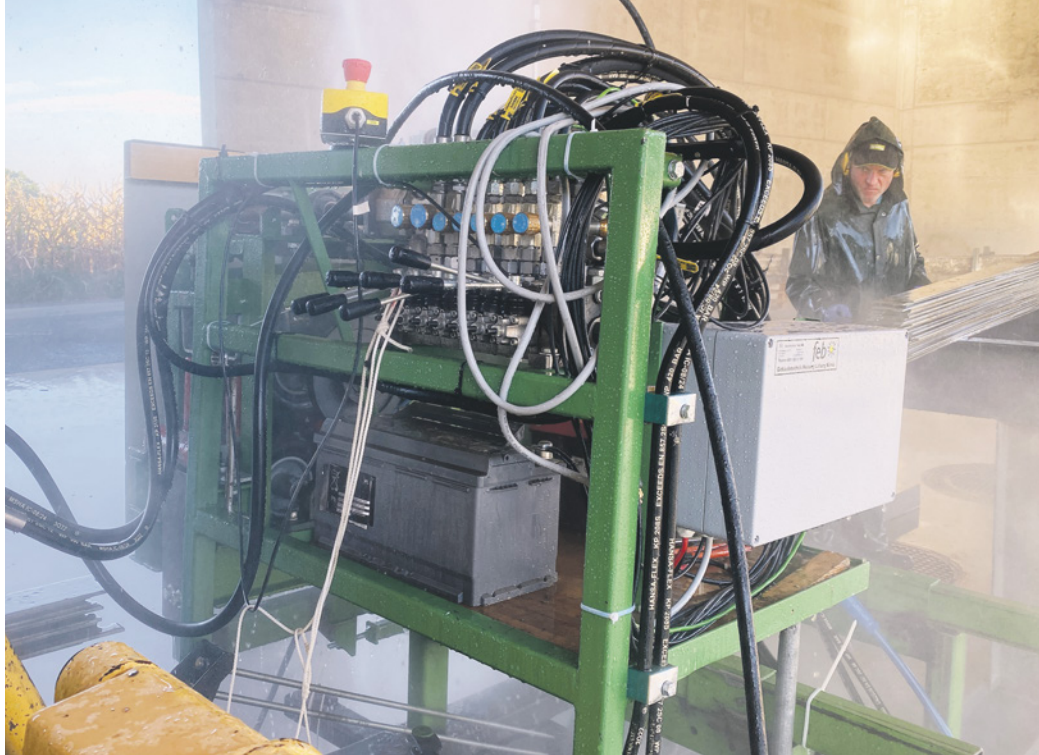
In Eberhards Maschine sind mehrere hydraulische Abläufe hintereinandergeschaltet. Die Reinigung erfolgt vollautomatisch.
