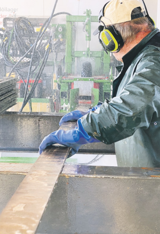
Die 11 kg schweren Eisen werden einzeln in die Maschine geschoben.
